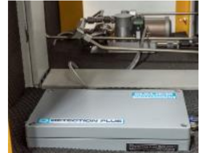
Integriertes B-DETECTION PLUS i in einen PE-VE Kompressor
